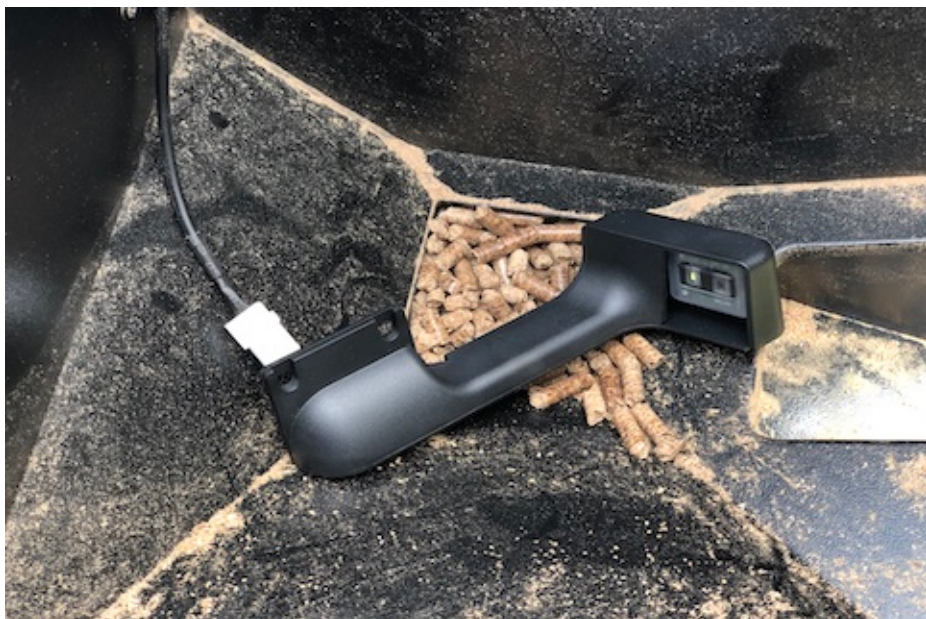
Montering af Traeger Pelletsensor
